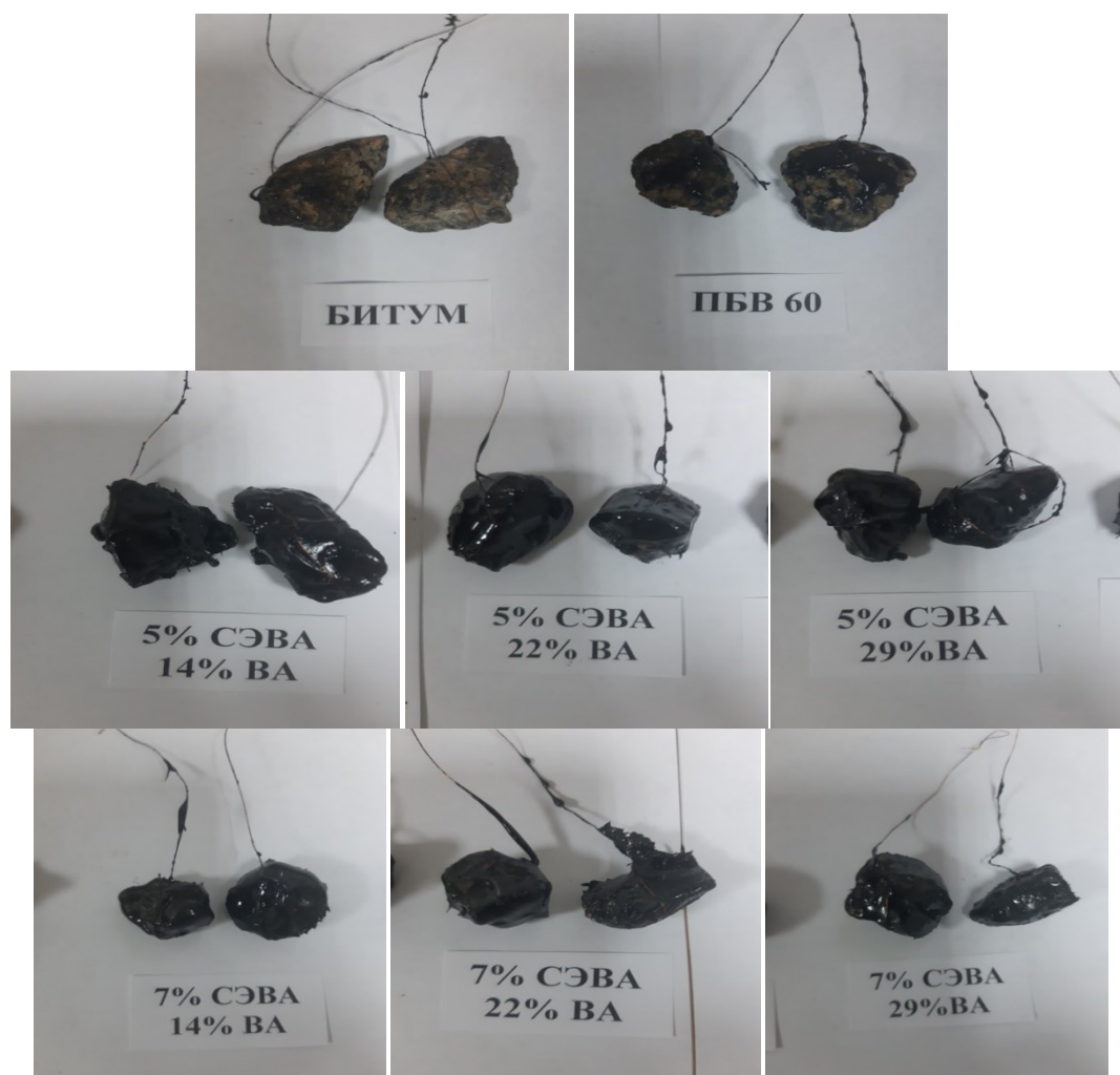
Рис. 2. Влияние севилена с различным содержанием винилацетата на адгезию битума к гранитному щебню
