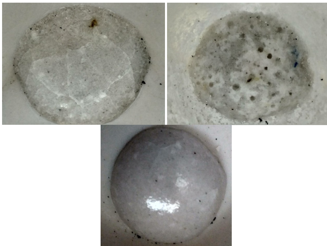
Рис. 4. Сравнение плавкости образцов при 900 °С.
